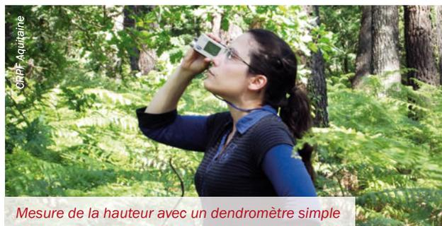
Mesure de la hauteur avec un dendromètre simple
