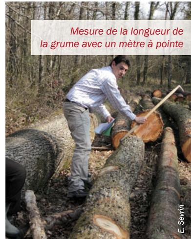
La mesure de la longueur s'effectue avec un mètre à pointe ou un ruban. Elle représente toujours la plus petite distance entre les sections extrêmes (en cas de coupe en biseau par exemple).
