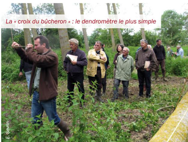
Le principe de la croix du bûcheron repose sur des relations de proportionnalité des triangles semblables. Il nécessite l'utilisation de 2 baguettes de bois de longueur égale. L'opérateur place une baguette sous son œil parallèlement au sol, la seconde étant ajustée verticalement. Il se positionne à la distance de l'arbre pour laquelle la ligne de visée du bas coïncide avec la base de l'arbre et celle
