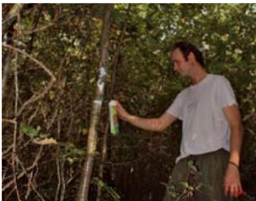
Chaque tige mesurée doit être numérotée et le niveau de mesure repéré à la peinture.
