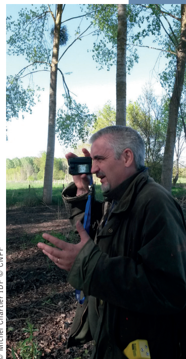
Mesure à l'aide du Vertex.
